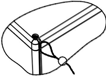
Пример пломбирования ТС на трубопроводе
